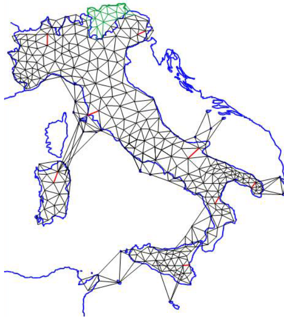
Figura 8.3 – Rete geodetica di triangolazione dell'IGM, Roma40
